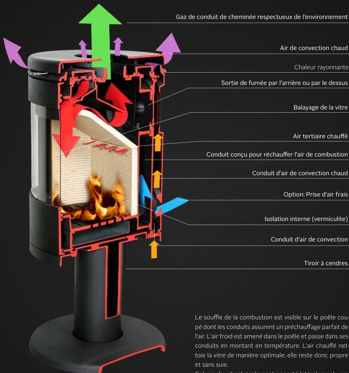
Le souffle de la combustion est visible sur le poêle coupé dont les conduits assurent un préchauffage parfait de l'air. L'air froid est amené dans le poêle et passe dans ses conduits en montant en température. L'air chauffé nettoie la vitre de manière optimale; elle reste donc propre et sans suie.
