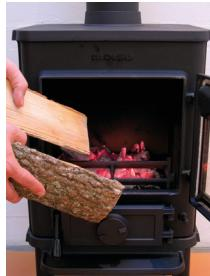
7. Når den sekundære lufttilførsel (øverste ventil) er åbnet på max. og døren lukkes, vil den friske træ mængde være antændt på et par minutter.
