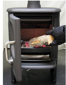
7. 2-3 Stücke Holzzscheite à ca. 0,7 kg bzw. 30 cm Länge in einer Schicht und unter Einhaltung von ca. 1 cm großen Abständen auf der Glut verteilen.
