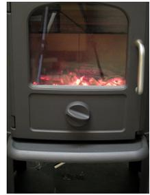
6. Neues Brennholz wird normalerweise nachgelegt, solange sich noch Glut im Ofen befindet. Verteilen Sie dazu die Glut auf dem Boden und achten Sie darauf, dass die meiste Glut vorne liegt.
