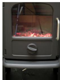
6. Der lægges 3 stykker brænde à ca. 0,7 kg og ca. 30 cm lange ind over gløderne i ét lag med en afstand på ca. 1 cm mellem træstykkerne.
