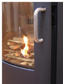
4. Når man kan se (efter 5-10 min.), at skorstenen er så varm, at der er træk igennem den, lukkes døren helt. Hvis alle forudsætninger er opfyldt, vil der efter yderligere ca. 15-20 min. være dannet et pænt glødelag i brændkammeret.
