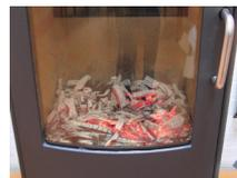
6. Der lægges 2 stykker brænde à ca. 0,7 kg og ca. 25-30 cm lange ind over gløderne i ét lag med en afstand på ca. 1 cm mellem træstykkerne.
