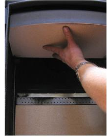
6. Stellen Sie sicher, dass die Rauchleitplatten und Steine wieder korrekt montiert sind, bevor Sie nach einer Reinigung den Kaminofen anheizen.
