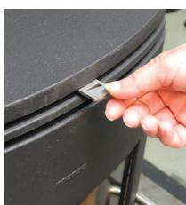
8. Baissez ensuite l'air de combustion sur la position désirée pour assurer une combustion optimale.
