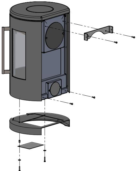
Lyft baskaminen på plats så att de två M8-skruvorna under kaminen passar in i de ovala hålen på väggfästet. Sätt fast kaminen med de två medföljande M6x12-skruvorna ovanpå och de två brickorna och M8-muttrarna under (se skiss). Det rekommenderas att man är två personer för detta arbete.
