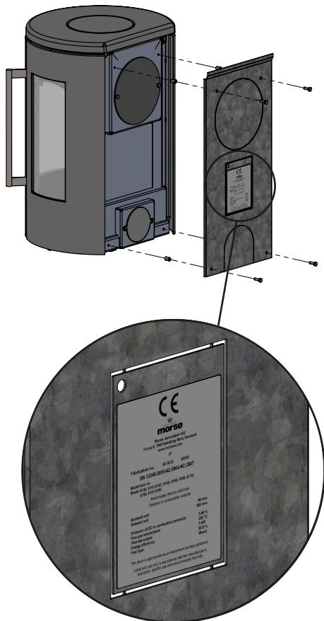
De twee schroeven die eerder werden gebruikt om het stralingsschild te bevestigen, worden aan de onderkant van de achterkant van de kachel gemonteerd om de gaten te sluiten.
