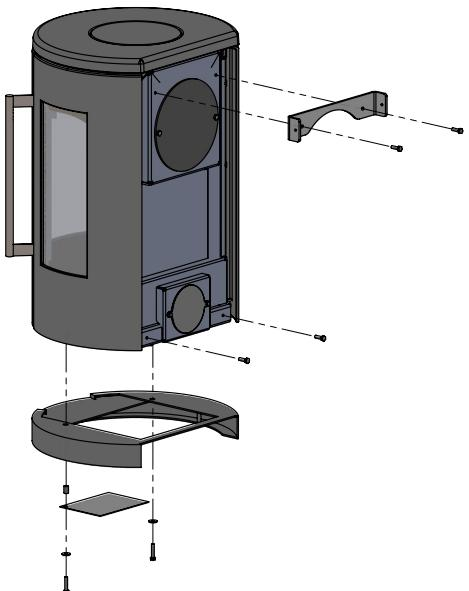
Levante la estufa básica hasta colocarla en su sitio, de modo que los dos tornillos M8 de la base de la estufa queden encajados en los dos orificios ovalados del soporte de montaje en pared. Realice el montaje de la estufa colocando los dos tornillos M6x12 suministrados en la parte superior y las dos arandelas y tuercas M8 debajo de la base (véase el esquema). Recomendamos que esta operación se realice entre 2 personas.
