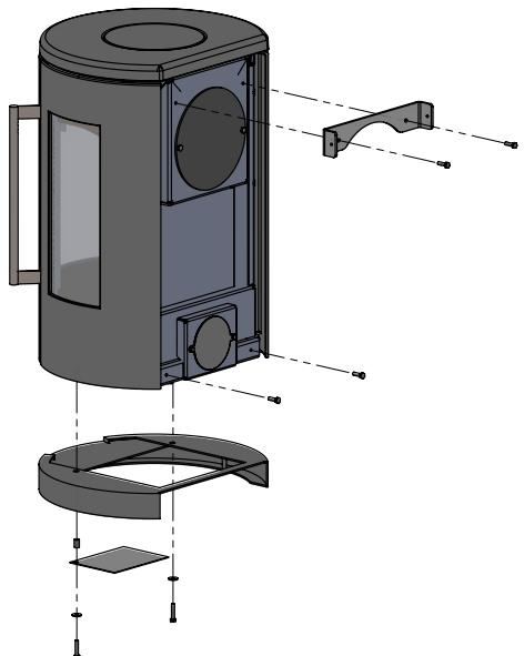
De basiskachel wordt dan in de juiste positie gebracht, zodat de twee M8-schroeven onderaan de kachel in de ovale openingen van het wandbeslag terechtkomen. Monteer de kachel met de twee M6x12-schroeven die zijn bijgevoegd aan de bovenzijde en monteer de twee M8-moeren en klemringen onderaan de kachel (zie tekening). We raden aan dat 2 personen dit werk uitvoeren.
