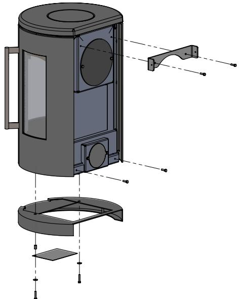
Basisovnen løftes på plads, så de to M8 skruer under bunden af ovnen rammer ned i de ovale huller på vægbeslaget. Ovnens fastgøres med de medfølgende 2 stk. M6x12 skruer i toppen og de to skiver og M8 møtrikker monteres under bunden (se skitse). Det anbefales at være 2 personer til dette arbejde.
