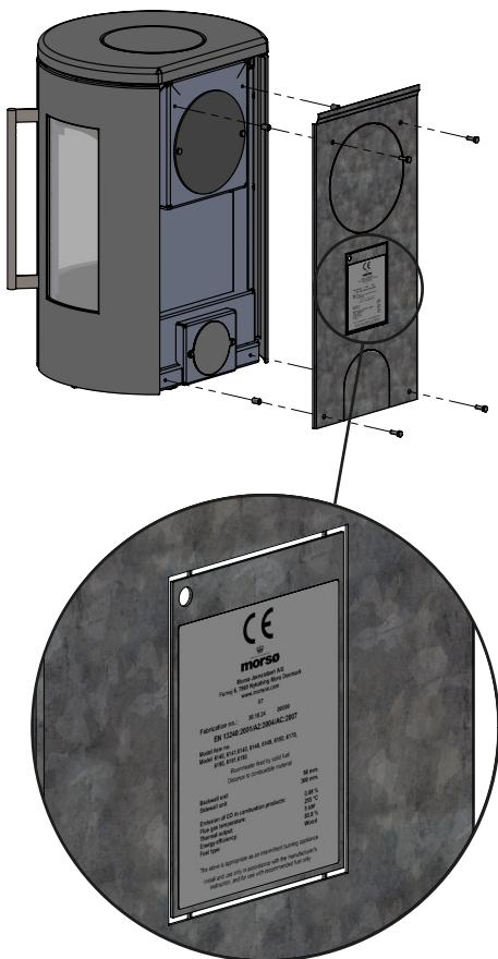
Les deux vis qui ont été utilisées pour fixer l'écran thermique sont montées en bas à l'arrière du poêle pour fermer les trous. Le support angulaire est monté avec les deux autres vis qui ont été utilisées pour fixer l'écran thermique. Sous le poêle, retirez 2 vis M6x25 et rondelles, ainsi que 2 vis M6x60.
