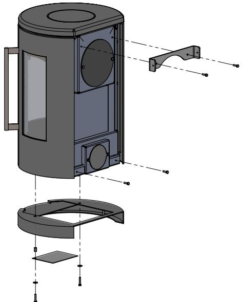
Installez le poêle en le soulevant, de telle sorte que les deux vis M8 situées en-dessous du poêle viennent s'intégrer dans les deux orifices ovales de la structure de fixation murale. Pour fixer le poêle, vissez en haut les deux vis M6x12 fournies, et installez en-dessous les deux rondelles et les écrous M8 (voir schéma). L'installation doit être réalisée par deux personnes.
