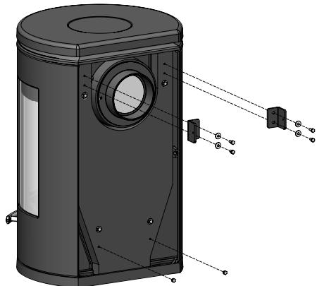
Avlägsna de två skruvarna som täpper till hålen högst upp (se skiss) och montera dem i botten för att täppa till hålen som har använts för att fästa strålskärmen.
