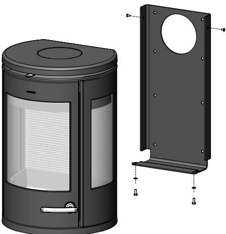
Il corpo della stufa deve essere sollevato nella posizione di installazione, in modo tale che la base poggi su lato inferiore dell'attacco a muro. La stufa deve essere fissata superiormente mediante le 2 viti M5x12 fornite, e inferiormente mediante 2 viti M8x16 e le rondelle fornite in dotazione (vedi schema). Per l'esecuzione di questa operazione è vivamente consigliabile utilizzare 2 persone.
