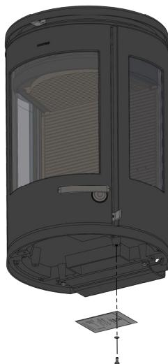
Fissa l'etichetta CE sotto il termocamino come mostrato. Usa la vite fornita con la rondella.
