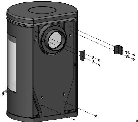
Le due viti che fissano in posizione i fori superiori devono essere rimosse (vedi schema), e riposizionate in basso, per sigillare i fori utilizzati per lo schermo paracalore.
