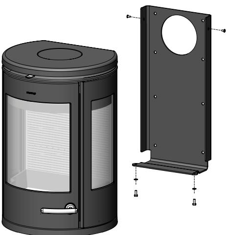
Der Basisofen wird an seinen Platz gehoben, so dass er auf dem Boden der Wandaufhängung zu sitzen kommt. Der Ofen muss mit den mitgelieferten zwei M5x12 Schrauben oben und den mitgelieferten zwei M8x16 Schrauben und Unterlegscheiben am Boden befestigt werden (siehe Abbildung). Wir empfehlen, diese Arbeiten mit zwei Personen auszuführen.
