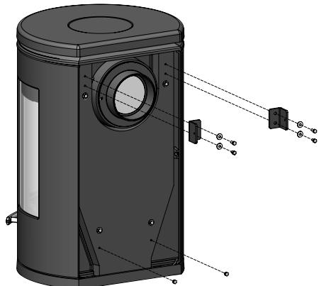
Die beiden Schrauben, mit denen die oberen Löcher verschlossen sind (siehe Abbildung) müssen entfernt und unten wieder eingeschraubt werden, um die Löcher zu schließen, mit denen der Hitzeschild befestigt wurde.
