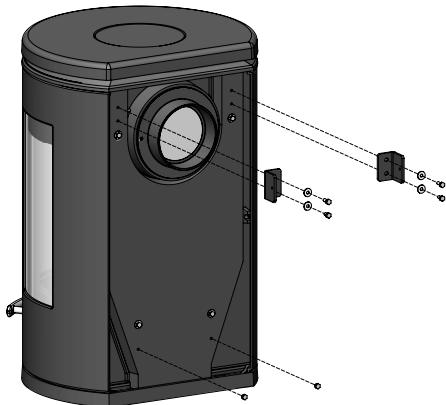
Les deux vis qui ferment les deux orifices supérieurs doivent être retirées (voir schéma) et vissées dans les orifices de fixation de l'écran thermique.
