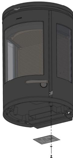
Monta la etiqueta CE debajo de la estufa como se muestra. Utilice el tornillo incluido con la arandela.
