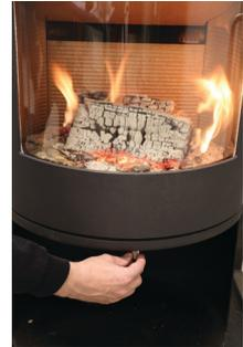
7. Danach die Verbrennungsluft in die gewünschte Position stellen, sodass der Verbrennungsvorgang weiterhin optimal verläuft.
