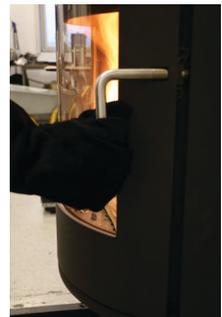
5. Ist die Voraussetzung unter Abschnitt 4 erfüllt, dort hinstellen 2-3 Stück Brennholz mit einem Gesamtgewicht von 1,5-2,5 kg u einer Länge von 25-35 cm über der Glut in höchstens 2 Lagen mit einem Abstand von ca. 1 cm zwischen den Holzstücken. Kein Brennholz dicht an das Glas des Ofens legen. Das kann dazu führen, dass es durch Ruß geschwärzt wird.
