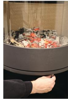
6. Bei einer Position der sekundären Luftzufuhr auf „Max.“ (offen) und geschlossener Tür zündet sich das neue Holz innerhalb einiger weniger Minuten an. Entflammt sich das Holz nicht, öffnen Sie die Tür einen Spalt breit um dadurch die für das Anzünden des Holzes erforderliche Luftmenge zuzuführen. Brennt das Holz, kann die Tür wieder geschlossen werden.
