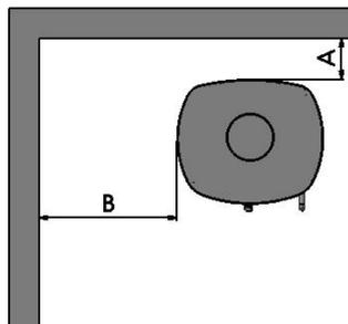
Mit Rücksicht auf Wärmezirkulation, Reinigung und evtl. Säuberung des Ofens von innen, sollte der Abstand zum Mauerwerk 20 cm betragen. Eine Schicht Tapete wird normalerweise, wenn sie auf Mauerwerk angebracht ist, nicht als brennbares Material angesehen.
