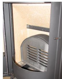
2. Med den ene hånd løftes nederste røgledeplade. Dermed kan man med den anden løfte sidestenen nogle centimeter op. Dette gøres nemmest med en ligekærvet skruetrækker eller lignende. Når stenen er løftet, tippes mellem bunden på plads igen og sidestenen kan dernæst komme fri af mellem bunden og løftes ud
