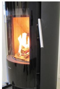
4. Når man kan se (efter 5-10 min.), at skorstenen er så varm, at der er træk igennem den, lukkes døren helt. Hvis alle forudsætninger er opfyldt, vil der efter yderligere ca. 15-20 min. være dannet et pænt glødelag i brandkammeret.
