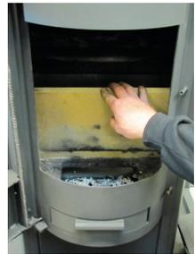
7. Die obere Rauchleitplatte aus den Halterungen herausheben und zum Ausbauen nach hinten unter die Halterungen hindurchführen.
