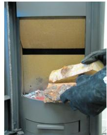
7. Bei einer Position der Luftzufuhr auf „Max.“ (offen) und geschlossener Tür zündet sich das neue Holz innerhalb we-niger Minuten an.
