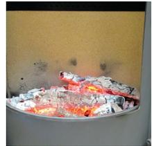
6. Verteilen Sie 2 Holz-scheite à ca. 0,7 kg mit einer Länge von ca. 25-30 cm in einem Abstand von ca. 1 cm zwischen den Scheiten längs in einer Schicht über die Glut.
