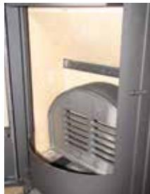
2. D'une main, levez la chicane pour la fumée inférieure. Vous pouvez ainsi, de l'autre main, lever la brique latérale de quelques centimètres. Aidez-vous d'un tourne-vis plat ou autre outil analogue. Une fois la brique levée, basculez à nouveau la plaque intermédiaire en place. La brique latérale est ainsi libérée et vous pouvez l'enlever.
