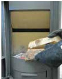
7. Quand l'admission d'air est ouverte au maximum et que la porte est fermée, le nouveau chargement de bois s'allumera en quelques minutes.
