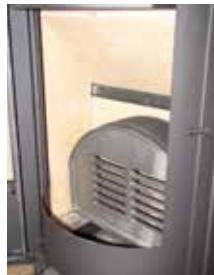
2. Til met een hand het onderste rookshot omhoog. Met de andere hand tilt u de steenplaat enkele centimeter omhoog. Gebruik hiervoor een platte schroevendraaier of een gelijkaardig hulpmiddel. Zodra de steenplaat werd omhooggetild, kantelt u het diafragma opnieuw op de plaats zodat de steenplaat nu los zit en kan worden verwijderd.
