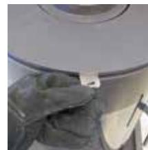
3. Nadat het papier/de aanmaakblokjes vlam hebben gevattet, zet u het deurtje op een kier van ongeveer 5-10 cm, zodat de schoorsteen goed kan trekken.
