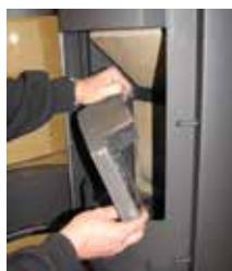
4. Levez à nouveau la chicane pour la fumée inférieure et basculez l'autre brique latérale hors du poêle
