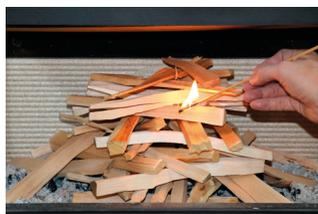
**4.** Après l'allumage, fermez partiellement les portes en les laissant entrouverte de 1 ou 2 pouces pour laisser entrer suffisamment d'air de combustion.
