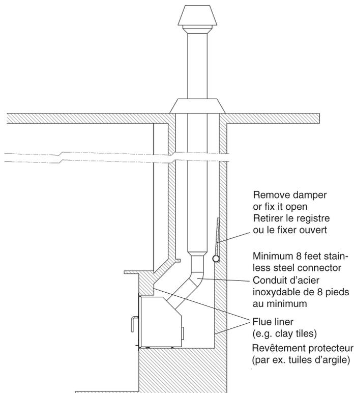
Le revêtement protecteur de cheminée en acier inoxydable (souple ou rigide) est disponible auprès de la plupart des revendeurs de poêles spécialisés. L'installation doit être utilisée avec une cheminée fabriquée en usine ou une cheminée en maçonnerie. S'assurer que toutes les exigences sont respectées.
