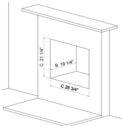
Le schéma ci-dessus indique les dimensions de foyer requises pour l'insert 5660 Morsø.
