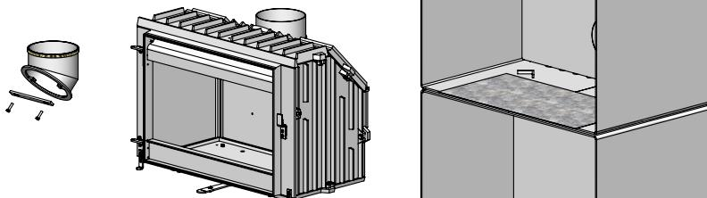
Nu placeres den underste stråleskærm løst under brændkammeret og de 2x3 stråleplader, der modtages samlet, placeres løst, et sæt i hver side (se skitse) uden at skubbes dem helt tilbage imod bagpladen i modulet. Endelig isættes vermiculite pladerne igen og slut med den øverste lodrette plade. Til sidst monteres døren igen.
