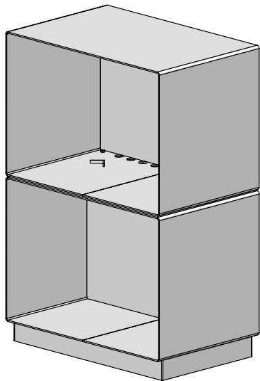
Herefter løftes modulet, forberedt til montering af ovnen, på plads. Sørg for at de to Ø10 huller bagst i modulet er lige over Ø10 hullerne i modulet under. Placer de to vedlagte M8x16 bolte i Ø10 hullerne, så de går gennem begge moduler. Inden placering af ovnen monteres stål bagpladen med de vedlagte magnetter. Den medfølgende glideplade lægges i bunden af modulet og skubbes ind til stofbåndet rammer kanten af modulet.
