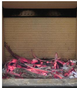
6. Der lægges 2-3 stykker brænde à ca. 0,7-1 kg og 30-50 cm lange ind over gløderne i ét lag med en afstand på ca. 1 cm mellem træ-stykkerne. Bedste forbrænding opnås hvis kævlernes længderetning er parallel med ovnens bagvæg.
