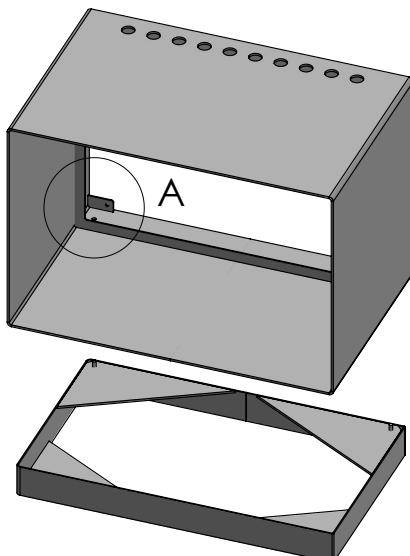
Soklen justeres i vater med stilleskruerne. Herefter placeres det modul, der med sine huller placeret bagerst på oversiden af modulet på soklen, så de to huller bagerst i bunden af modulet rammer ned over boltene på soklen (se skitse A og B). Soklen og modulet skrues sammen med de medfølgende skiver og møtrikker (se skitse C).
