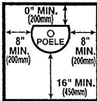
LE PROTECTEUR DE PLANCHER DOIT ÊTRE D'UN MATÉRIEL INCOMBUSTIBLE. IL DOIT S'ÉTENDRE EN DESSOUS DE L'APPAREIL ET AU DEVANT, AUX CÔTÉS ET À L'ARRIÈRE DE L'APPAREIL COMME INDICÉ.
