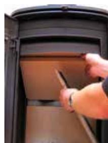
4. Une fois les briques latérales retirées, abaissez le déflecteur inférieur et retirez-le de la chambre de combustion en le soulevant.
