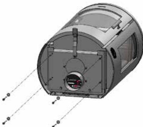
Till sist monteras lådan på plats igen med de borttagna fyra skruvarna.
