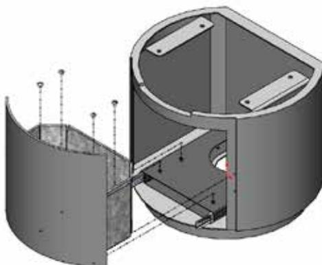
L'écran thermique fourni avec le cendrier doit être installé lorsque vous vissez le soubassement (voir le schéma).
