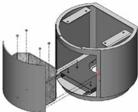
Lo schermo paracalore fornito in dotazione con il vassoio di raccolta deve essere installato assieme ai plinti. (vedere schema).
