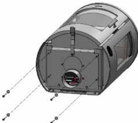
Zum Schluss wird die Schublade mit den vier herausgedrehten Schrauben wieder montiert.
