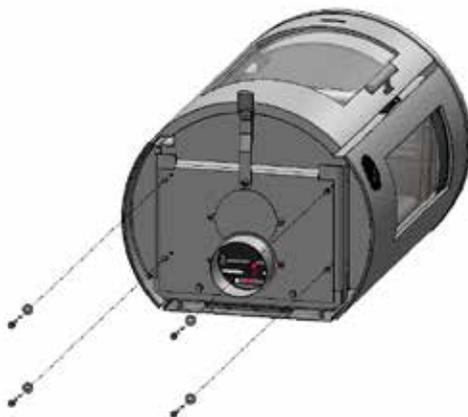
Ten slotte plaatst u de lade terug met behulp van de vier schroeven die u eerder hebt verwijderd.
