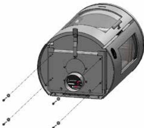
Infine, reinstallare il vassoio di raccolta mediante le quattro viti rimosse in precedenza.
