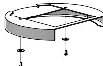
Levante la estufa básica hasta colocarla en su sitio, de modo que los dos tornillos M8 de la base de la estufa queden encajados en los dos orificios ovalados del soporte de montaje en pared. Realice el montaje de la estufa colocando los dos tornillos M6x12 suministrados en la parte superior y las dos arandelas y tuercas M8 debajo de la base (véase el esquema). Recomendamos que esta operación se realice entre 2 personas.
