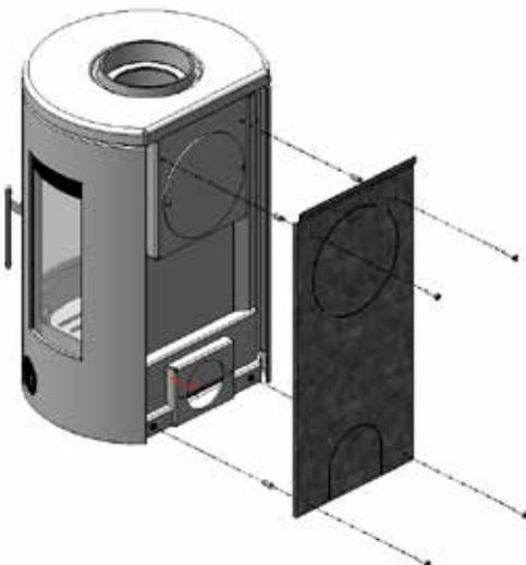
Skruta av strålskärmen på baksidan av kaminen eftersom den inte ska användas på den väggmonterade versionen.
