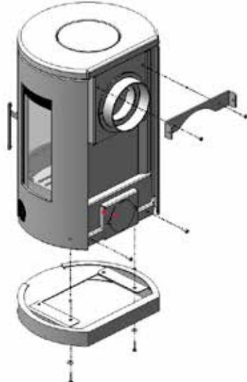
Soulevez le poêle pour le poser sur la partie inférieure de la structure de fixation. Montez le poêle à l'aide des 2 vis n° M6x12 fournies, sur le dessus, et des deux autres vis M6x25 et rondelles précédemment retirées, en bas. (voir schéma). L'installation doit être réalisée par deux personnes.
