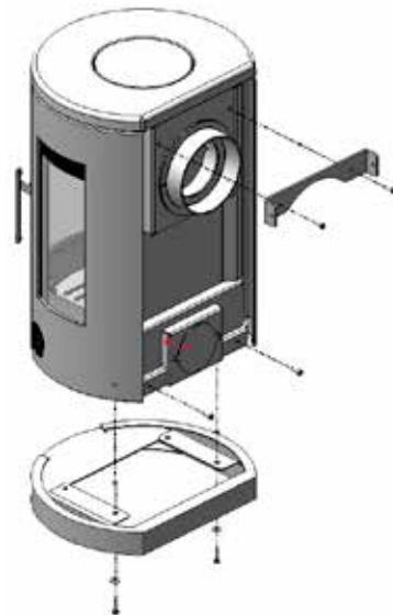
De basiskachel wordt dan in de juiste positie gebracht, zodat ze op onderkant van het wandframe aansluit.
