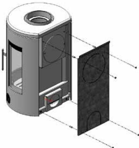
Después de desembalar la estufa básica, retire las piezas que se entregan sueltas. Se debe retirar el cajón de ceniza, el deflector de humos inferior fabricado de vermiculita, la parrilla de hierro fundido y la base intermedia.
