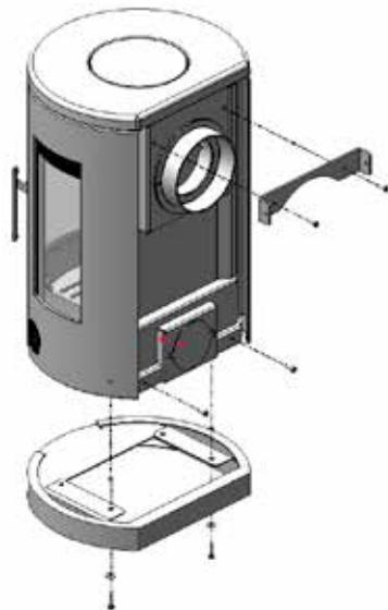
Coloque la estufa básica de forma que se asiente bien en la parte inferior del soporte de montaje en pared.
