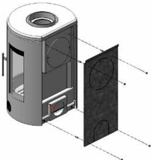
Verwijder, na het uitpakken van de eigenlijke kachel, de losse onderdelen. De aslaade, het vermiculieten rookschat, het gietijzeren rooster en de tussenbasis moeten worden verwijderd.
