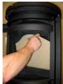
6. Bitte stellen Sie sicher, dass die Rauchleit- und Steinplatten vor dem erneuten Anzünden nach einer Reinigung wieder richtig montiert worden sind.
