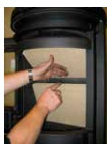
5. Lever et sortir de son support la chicane pour la fumée supérieure et la basculer pour la sortir.
