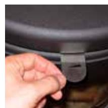
3. Nadat het papier/de aanmaakblokjes vlam hebben gevatt, zet u het deurtje op een kier van ongeveer 5 à 10 cm, zodat de schoorsteen goed kan trekken.
