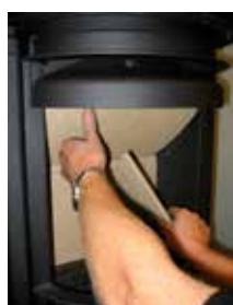
4. Après avoir enlevé les briques latérales et la brique arrière, abaisser la chicane pour la fumée inférieure et la sortir en la levant.
