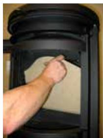
6. Il faut s'assurer que les chicanes pour la fumée et les briques sont à nouveau correctement montées avant de faire du feu après un nettoyage.
