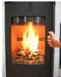
5. Er forudsætningen under pkt. 4 opfyldt, lægges der max. 3 stykker brænde med en samlet vægt på 1,5-2,5 kg og en længde på 25-30 cm ind over gløderne i ét lag med en afstand på ca. 1 cm mellem træstykkerne.
