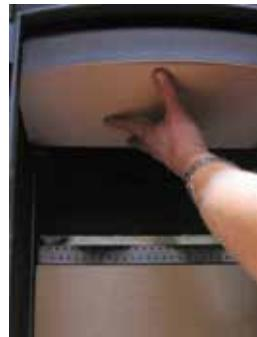
6. Man skal sikre sig, at røgledeplader og sten igen er korrekt monteret inden optænding efter en rensning.
