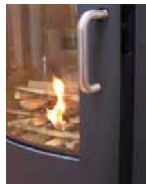
4. Når man kan se (efter 5-10 min.), at skorstenen er så varm, at der er træk igennem den, lukkes døren helt. Hvis alle forudsætninger er opfyldt, vil der efter yderligere ca. 15-20 min. være dannet et tykt glødelag i brandkammeret og der vil være en høj temperatur i brændkammeret, som er nødvendig for at kunne fortsætte forbrændingsfasen.
