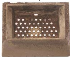
Brændskål med huller tilstoppet af aske. Skal rengøres
