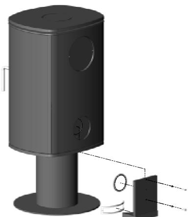
Si la conexión de aire fresco se debe instalar en una estufa de pedestal, se necesitan una caja de aire fresco, una junta de cuerda y 2 tornillos M6x30 con arandelas. La junta de cuerda se debe instalar alrededor del hueco rectangular en el tope del pedestal así como alrededor del hueco detrás de la caja, la cual se la pone en su sitio desde abajo y se atornilla después a la estufa con los 2 tornillos y arandelas.
