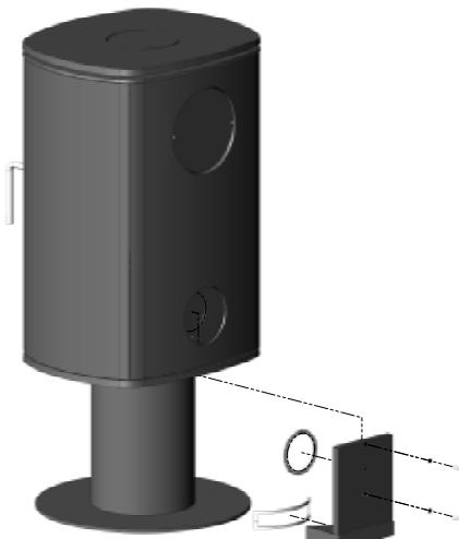
Vid montering av friskluftssystemet på piedestalmodellen består satsen av en låda, packningsrep och två (2) st M6x30-skruvar med brickor. Placera packningsrepet runt om det rektangulära hålet överst i piedestalrören och på samma sätt runt om hålet på lådans baksida. Skjut sedan lådan på plats nedifrån och uppåt och skruva fast den på kaminen med de medföljande spänbrickorna och M6x30-skruvarna.
