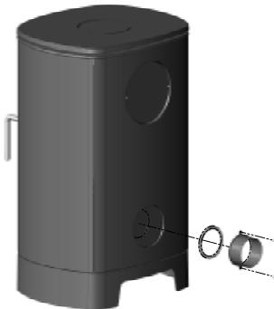
Il kit di installazione dell'attacco del sistema di ventilazione dal lato inferiore include un airbox, fune sigillante e 2 viti M6x30 con relative rondelle. Il nastro sigillante deve essere posizionato attorno al foro posto sul retro dell'airbox, per essere poi spinto in sede dal lato inferiore e avvitato sul corpo stufa mediante le due viti M6x08 fornite in dotazione.
