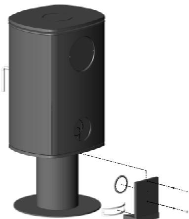
Il kit di installazione dell'attacco del sistema di ventilazione su un piedistallo include un airbox, fune sigillante e 2 viti M6x30 con relative rondelle. Il nastro sigillante deve essere posizionato attorno al foro rettangolare posto sul lato superiore del tubo del piedistallo, e attorno al foro posto sul retro dell'airbox. Quindi, è necessario spingere verso l'alto dal lato inferiore per inserire l'elemento in sede e quindi avvitare sul corpo stufa con le viti M6x30 fornite in dotazione.
