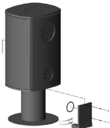
Ved montering af friskluft på piedestal udgaven består sætten af en boks, pakningssnor og 2 stk. M6x30 skruer med skiver. Pakningssnoren placeres rundt om det rektangulære hul i toppen af piedestal røret, og ligeledes rundt om hullet på bagsiden af boksen, der herefter nedefra skubbes op på plads, og skrues fast på ovnen med de medfølgende spændeskiver og M6x30 skruer.
