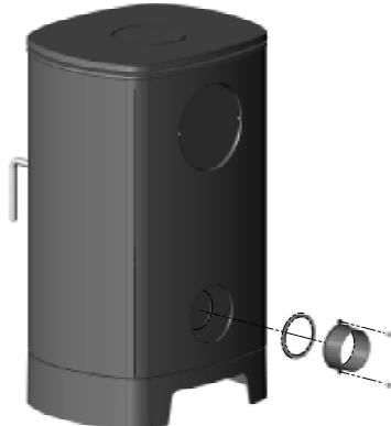
Wenn der Frischluftanschluss nach unten montiert werden soll, benötigen Sie eine Frischluftbox, Dichtungsschnur und 2 Schrauben (M6x30) mit Unterlegscheiben. Die Dichtungsschnur wird hinten an der Frischluftbox montiert, die danach an ihren Platz geschoben wird und mit den mitgelieferten Schrauben und Unterlegscheiben festgeschraubt wird.
