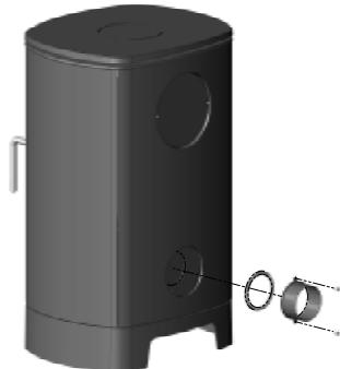
Voor de montage van de verseluchtinlaat via de onderzijde bevat de set een kamer, een afdichtingskoord en 2 schroeven nr. M6x30 met sluitringen. De afdichtingskoord moet rond de opening worden geplaatst aan de achterzijde van de kamer, die vervolgens via de onderzijde omhoog in de juiste positie wordt geduwd en op de kachel wordt geschroefd met de bijgeleverde borgringen en M6x30-schroeven.
