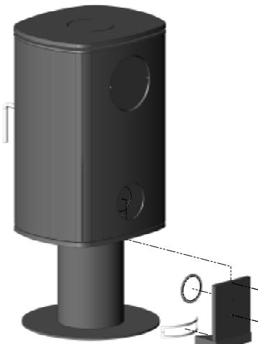
Ved montering av friskluft på pidestallutgaven består settet av en boks, pakningssnor og 2 stk. M6x30-skruer med skiver. Plasser pakningssnoren rundt det rektangulære hullet på toppen av pidestallrøret og liketan på baksiden av boksen, som deretter skyves på plass nedenfra og opp, og skrus fast på ovnen med de medfølgende spennskivene og M6x30-skruene.
