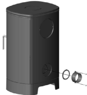
När friskluftsystemet monteras nedtill består satsen av en låda, packningsrep, och två (2) st M6x30-skruvar med brickor. Placera packningsrepet runtom hålet baktill på lådan. Skjut sedan upp lådan på plats och skruva fast den på kaminen med de medföljande spänbrickorna och M6x30-skruvarna.
