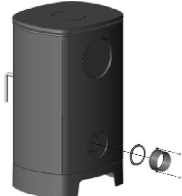
Ved montering av friskluft på nedsiden består settet av en boks, pakningssnor og 2 stk. M6x30-skruer med skiver. Plasser pakningssnoren rundt hullet på baksiden av boksen, som deretter skyves på plass nedenfra og opp, og skrus fast på ovnen med de medfølgende spennskivene og M6x30-skruene.
