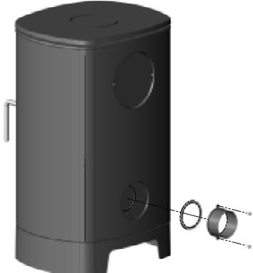
Ved montering af friskluft nedenud består sætten af en boks, pakningssnor, og 2 stk. M6x30 skruer med skiver. Pakningssnoren placeres rundt om hullet på bagsiden af boksen, der herefter nedefra skubbes op på plads og skrues fast på ovnen med de medfølgende spændeskiver og M6x30 skruer.
