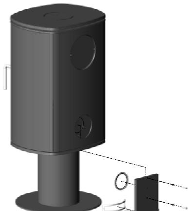
Voor de montage van de verseluchtinlaat op een onderstel bevat de set een kamer, een afdichtingskoord en 2 schroeven nr. M6x30 met sluitringen. De afdichtingskoord moet rond de rechthoekige opening worden geplaatst op de bovenzijde van de buis van het onderstel, en ook rond de opening aan de achterzijde van de kamer, die vervolgens via de onderzijde omhoog wordt geduwd in de juiste positie, en op de kachel wordt geschroefd met de bijgeleverde borgringen en M6x30-schroeven.
