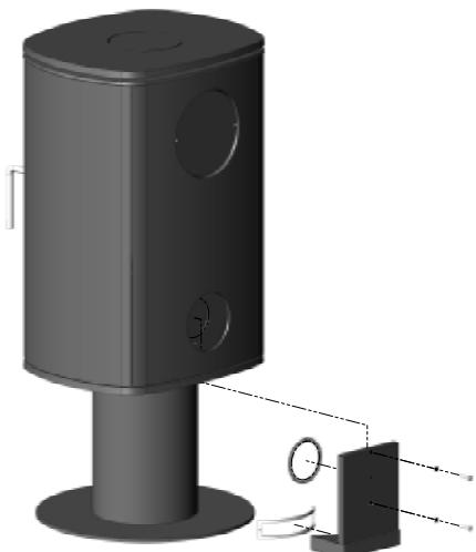
Pour l'installation de la prise d'air sur un piédestal, le kit comprend un boîtier, un cordon d'étanchéité et deux vis M6x30 avec rondelles. Le cordon d'étanchéité doit être placé autour de l'orifice rectangulaire du tuyau du piédestal, et aussi autour de l'orifice à l'arrière du boîtier, qui est ensuite poussé en position par en-dessous, puis vissé sur le poêle avec les deux vis M6x30 et les rondelles bloquantes fournies.
