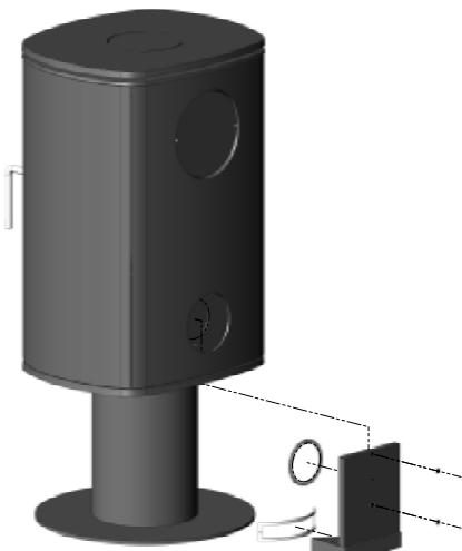
Wenn der Frischluftanschluss auf einem Ofen mit Säulenpodeste montiert werden soll, benötigen Sie eine Frischluftbox, Dichtungsschnur und 2 Schrauben (M6x30) mit Unterlegscheiben. Die Dichtungsschnur wird um das rechtwinklige Loch oben an der Säulenpodeste montiert und wird auch hinten an der Frischluftbox montiert. Die Box wird danach an ihren Platz geschoben und wird mit den mitgelieferten Schrauben und Unterlegscheiben festgeschraubt.
