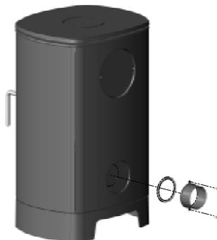
Si la conexión de aire fresco se debe instalar hacia abajo, se necesitan una caja de aire fresco, una junta de cuerda y 2 tornillos M6x30 con arandelas. La junta de cuerda se debe instalar alrededor del hueco detrás de la caja, la cual se la pone en su sitio desde abajo y se atornilla después a la estufa con los 2 tornillos y arandelas.
